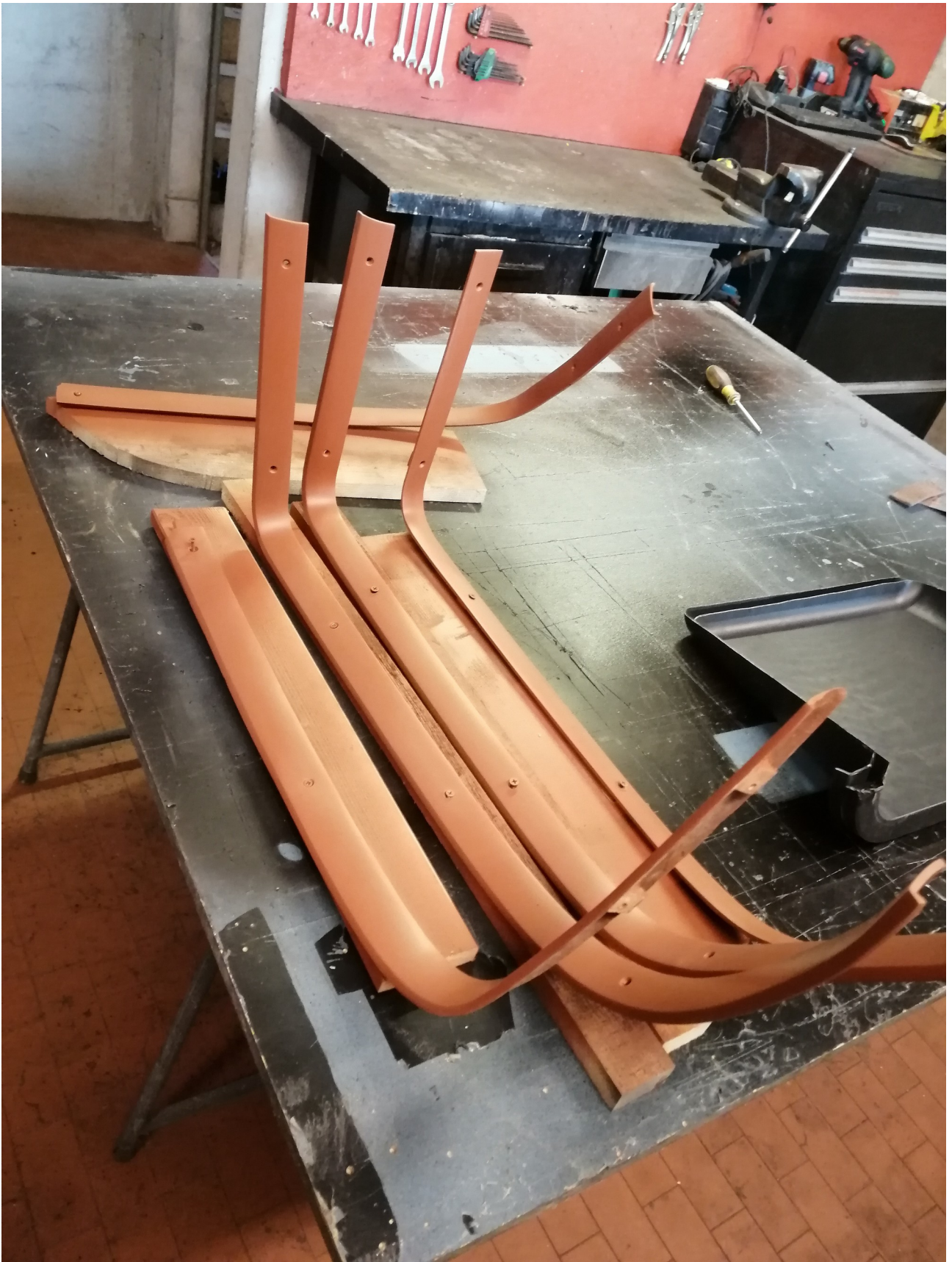
Teile geschliffen und grundiert
