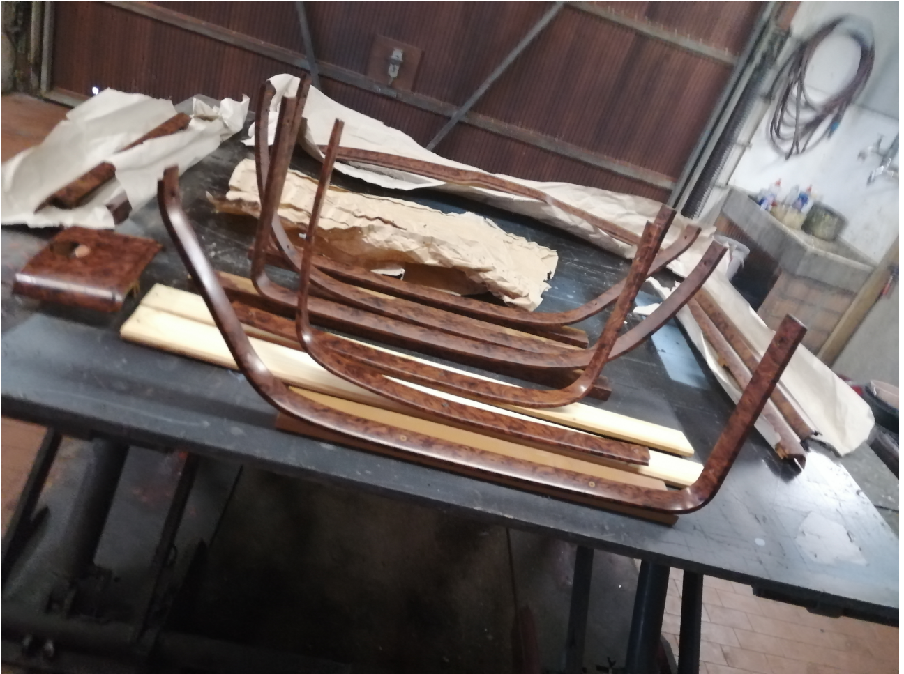
Teile mit Wasser Transferlack überzogen
