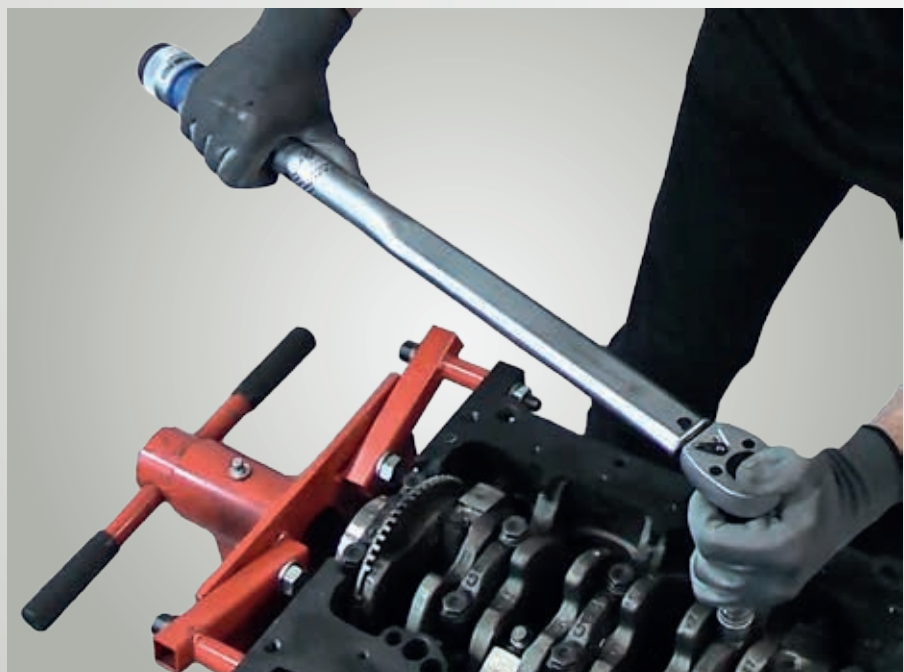
Abb. 1: Anzug der Schrauben gemäß Herstellervorgaben
