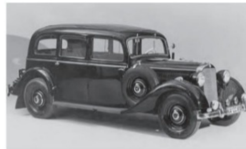
Die Diesel-Revolution begann im Februar 1936: Auf der Internationalen Motorrad- und Automobilausstellung in Berlin stand der Mercedes-Benz 260 D der Baureihe W 138 – der damals erste serienmässige Diesel-Pkw der Welt. © Mercedes-Benz AG
