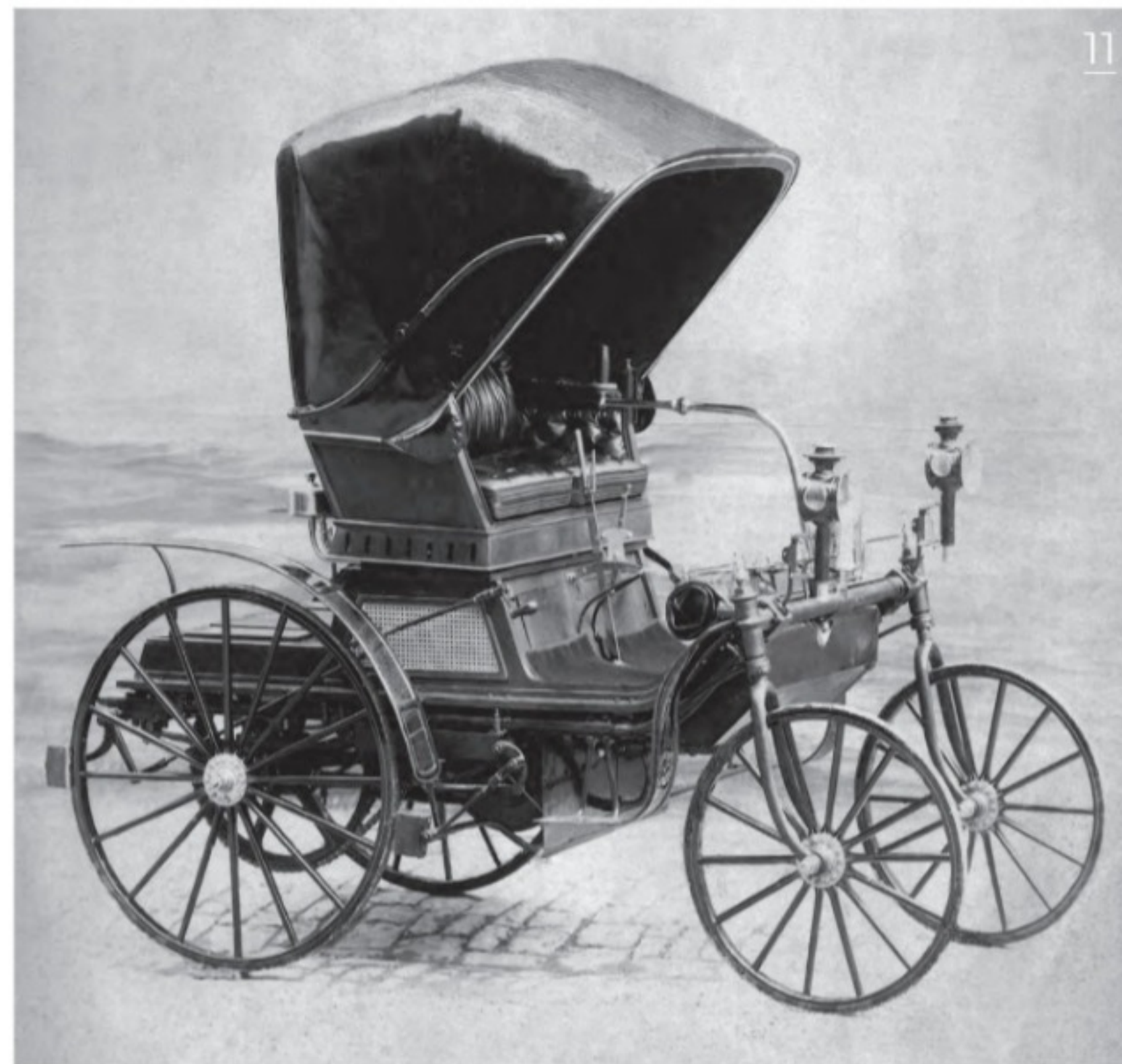
Daimler-Wagen mit Kettenantrieb («Schroeder-Wagen») aus dem Jahre 1892. © Mercedes-Benz AG
