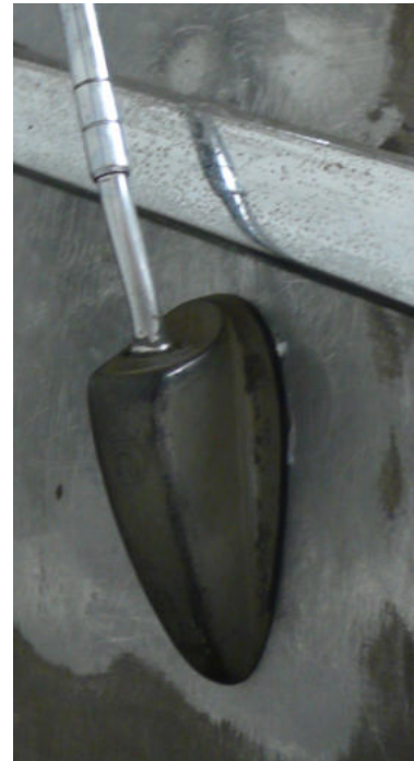
Älterer Antennenfuss über dem Isolierteil das dünnere angepasste Biestück
