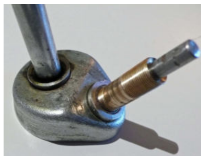
Neue Messing-Buchse für Abtrieb mit Gewinde M10x0.75
