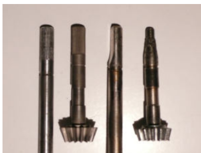
Wellen mit Riffelung, Abflachung und Konus mit Gewinde M4
