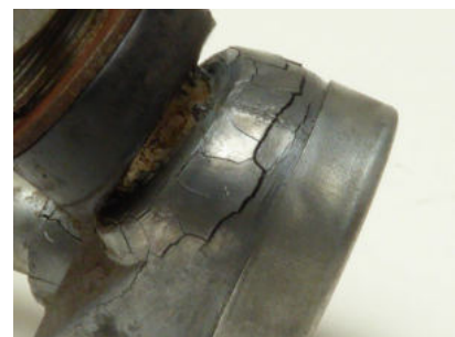
Rissbild am Zinkspritzguss-Gehäuse
