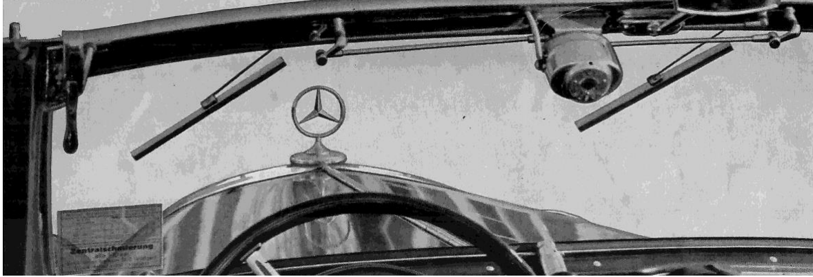
Wischerantrieb Bildausschnitt aus Prospekt 170V CB 1939
