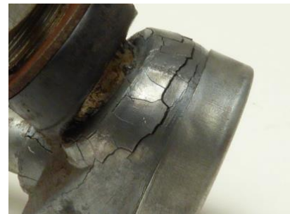
Rissbild am Zinkspritzguss-Gehäuse
