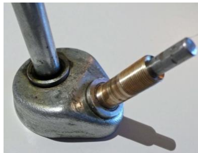
Neue Messing-Buchse für Abtrieb mit Gewinde M10x0.75
