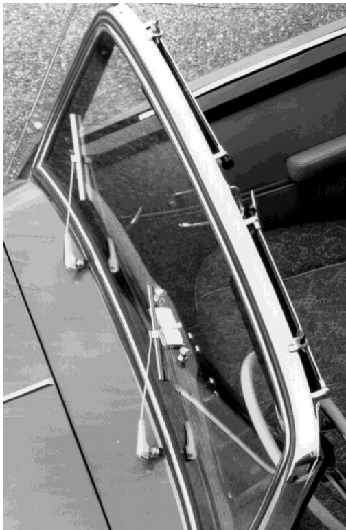
170S CA Arm aus rundem Draht
