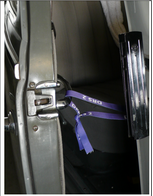
Geöffnete Türe mit eingehängtem Band. Die Länge der Bänder ist so zu wählen, dass von aussen die Bänder ausgehängt und die Türen geöffnet werden können.
