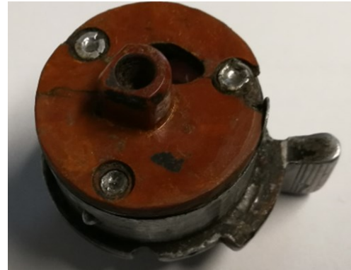
Schließmechanik mit gebrochener Pertinaxplatte
