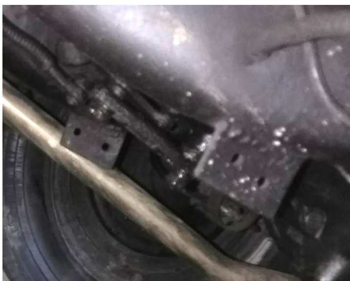
An den Längsholmen angeschweisste Befestigungslaschen
