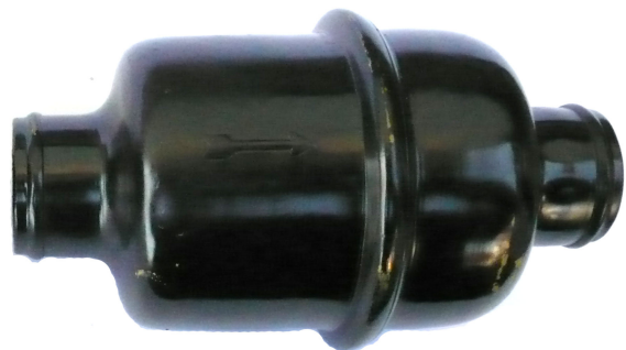
Schlauchthermostet Mekanostat mit grösserem Gehäuse-Durchmesser wurde oft als Ersatz eingebaut. und eignet sich besser für den Einbau eines modernen Thermostaten
