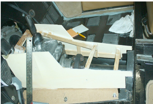
Bild 4 und 5: Beplankung mit Sperrholz
