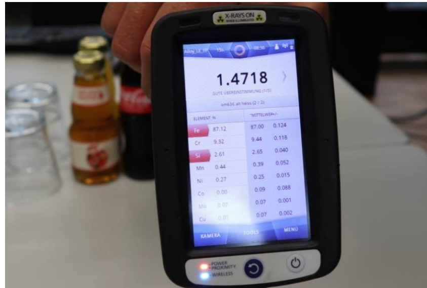
Bild 8/1: Prüfling Nr.1, Materialanalyse „Heißer Teil“
