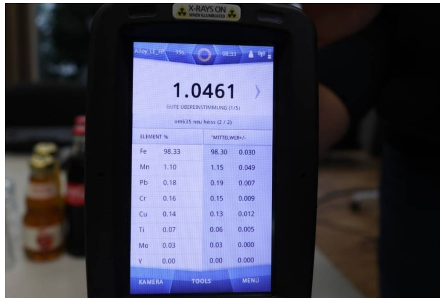
Bild 8/2: Prüfling Nr.2, Materialanalyse „Heißer Teil“
