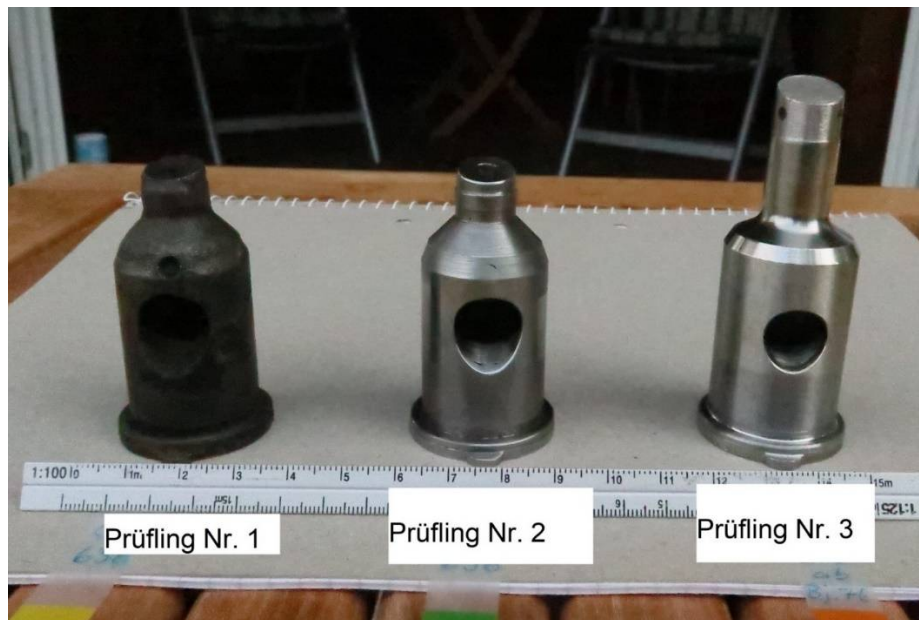
Bild 1: Die drei Vorkammer-Prüflinge
