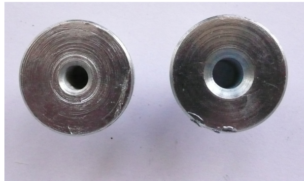
Achse links mit Gewinde rechts mit Bohrung
