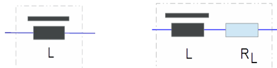
Bild 55: Ideale und reale Spule Eine reale Spule verhält sich wie eine ideale Spule, der ein Widerstand in Serie geschaltet ist.
