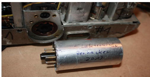
Abbildung 6.13: Zerhackerpatrone (KACO) mit neuem, elektronischem Innenleben
