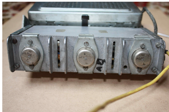
Abbildung 7.5: Rückseite des Endstufen- und Wandlerteils eines Blaupunkt Köln TR
