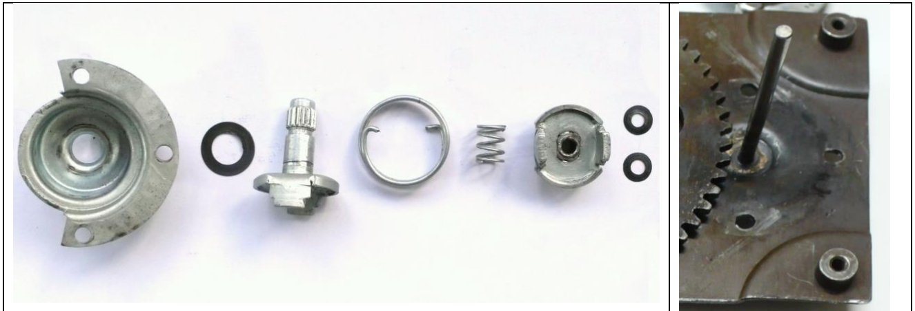
Gehäuse Pass- Achse Feder- Distanz- Gegenstk. Pass- Dorn hart in Dreh Sperre Scheibe Fenster- Kurbel hemmung Feder mit Zahnrad Scheiben Tragblech eingelötet
