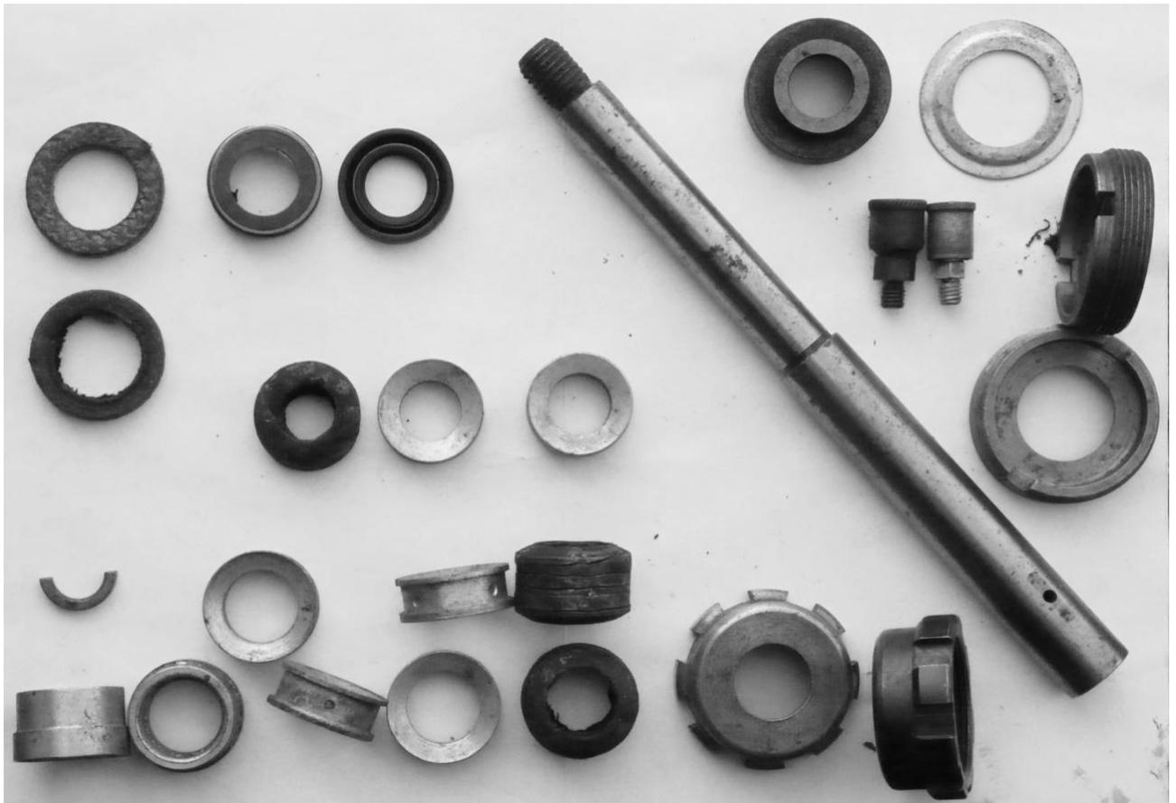
**WaPu mit Schmiernippel mit kleiner Schleifringdichtung, mit 2 Bohrungen für den Leckwasser-Austritt, Welle D durchgehend 15 mm**
