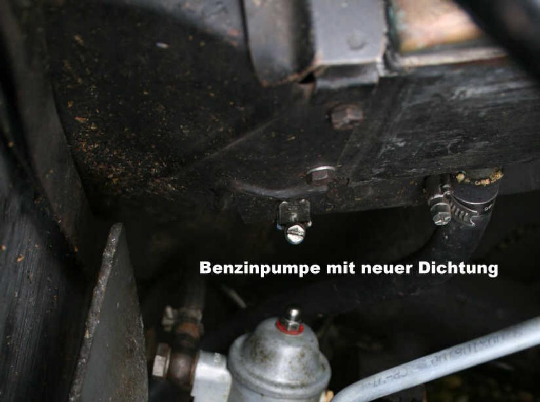
**Benzinpumpe mit neuer Dichtung**
