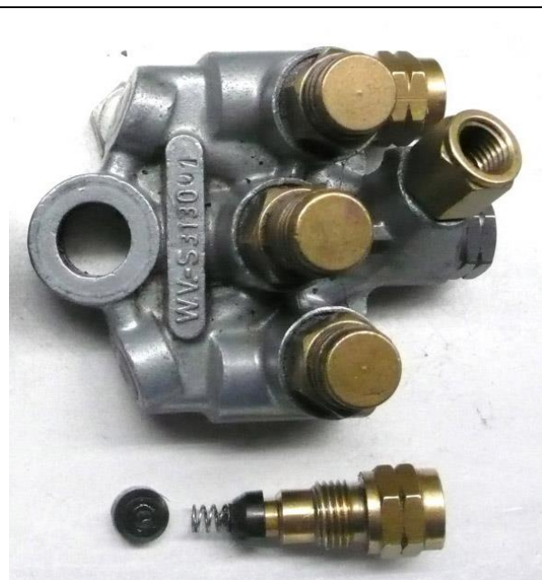
WV-S Verteiler auf Achsschenkel Verschraubungen mit Kerbe gekennzeichnet Achtung: Kein Linksgewinde Die kleine Feder vor der Manschette soll vermutlich das Nachtropfen verhindern.
