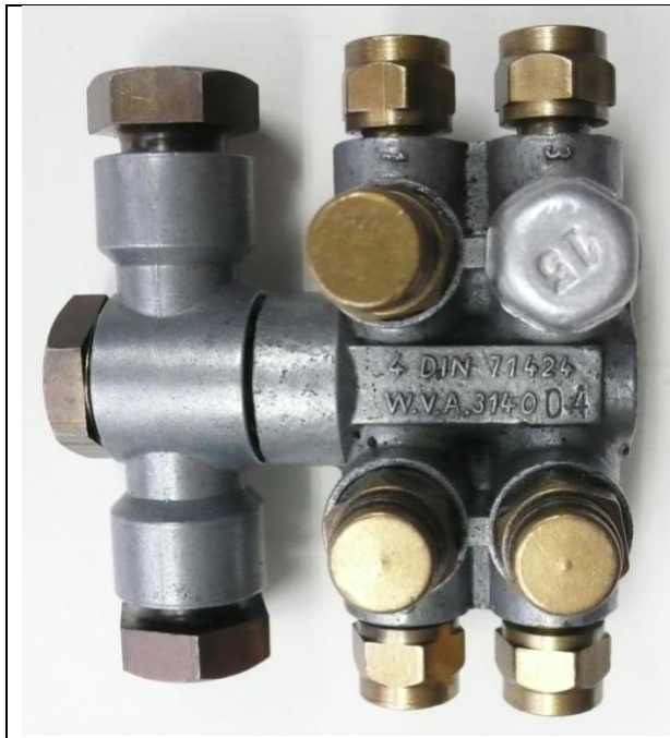
WVA Verteiler am Rahmen älteres System mit grosser Feder hinter der Manschete
