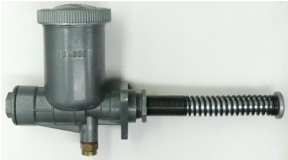
Pumpe mit separatem Ölbehälter in Einzelteile zerlegt Bild aus dem 170v-Forum
