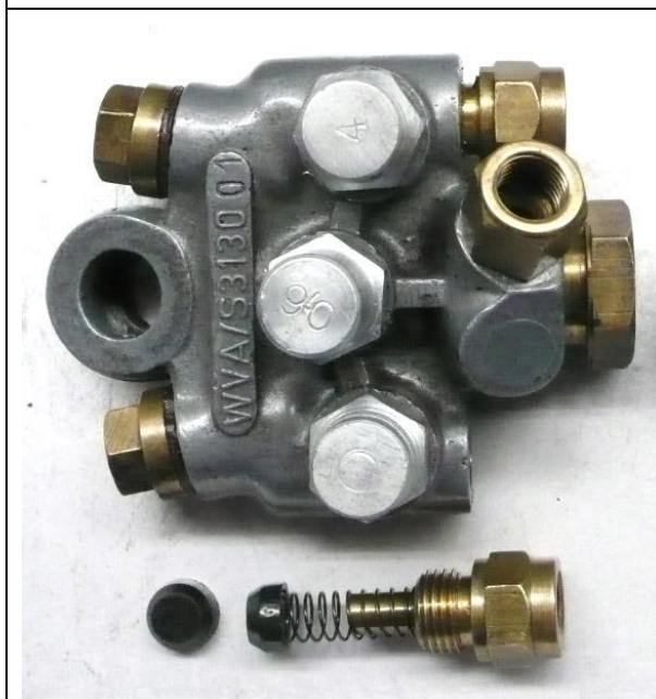
WVA/S Verteiler auf Achsschenkel älteres System mit grosser Feder hinter der Manschete Feder liegt in Ringnut
