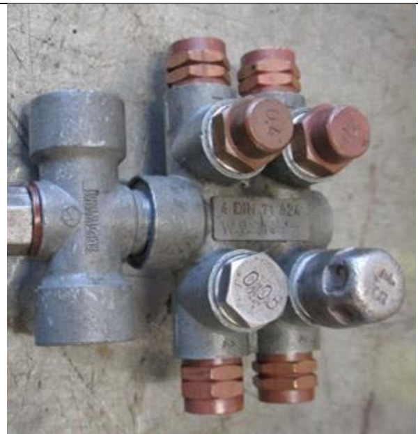
WV-S Verteiler am Rahmen Verschraubungen mit Kerbe gekennzeichnet Achtung: Kein Linksgewinde
