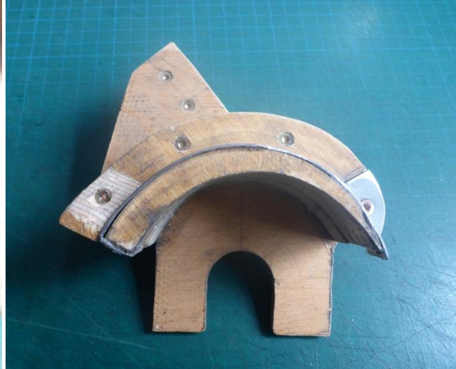
Grundplatte, Befestigung der Blechverstärkung
