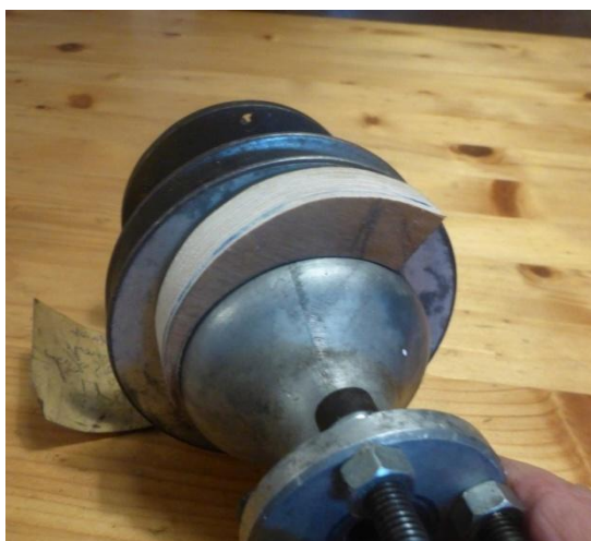
Schneckenförmige Rampe, gleichzeitig auch hintere Abstützung
