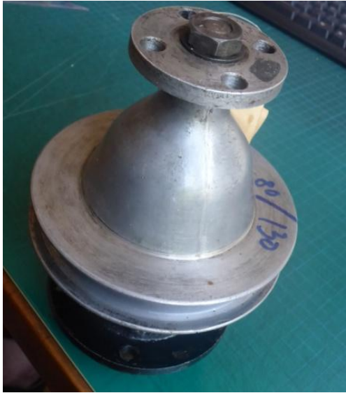
D-außen = 130, Riemenscheibe rein Alu, ohne Armierung
