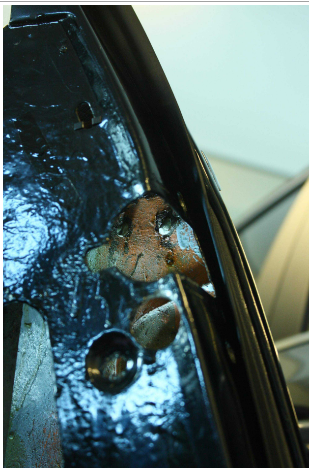
Bild-1_Sicht auf die Bruchstelle durch die Öffnung des Türbolzens.
