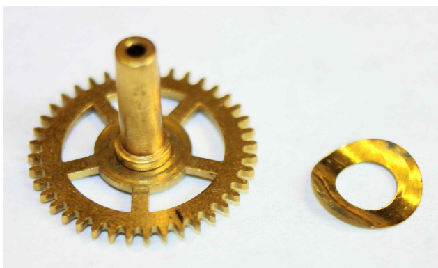
Abbildung 3.2: Stundenrad und Druckscheibe
