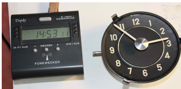
Abbildung 8.1: Justage, Uhr mit Vergleichsuhr
