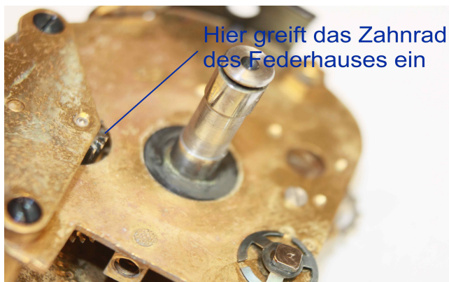
Abbildung 6.3: Untere Platine mit Bolzen für Federhaus
