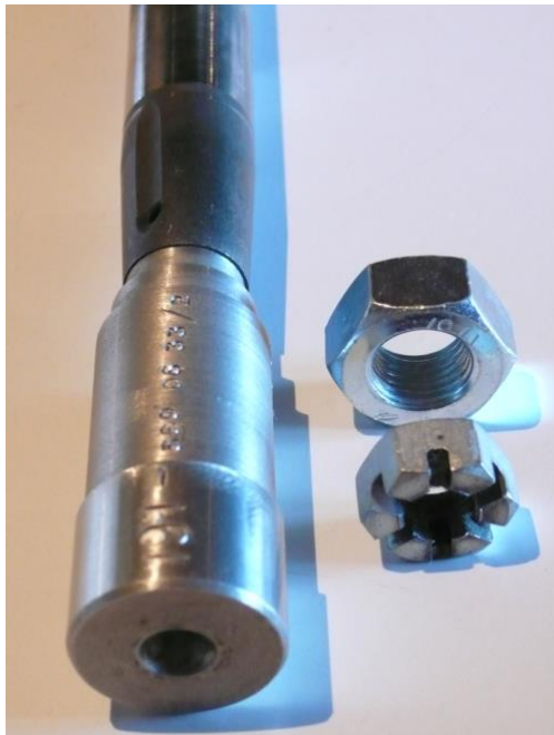
Schutzhülse zum Abpressen der oberen Achsschenkelkfaust für beide Achssysteme
