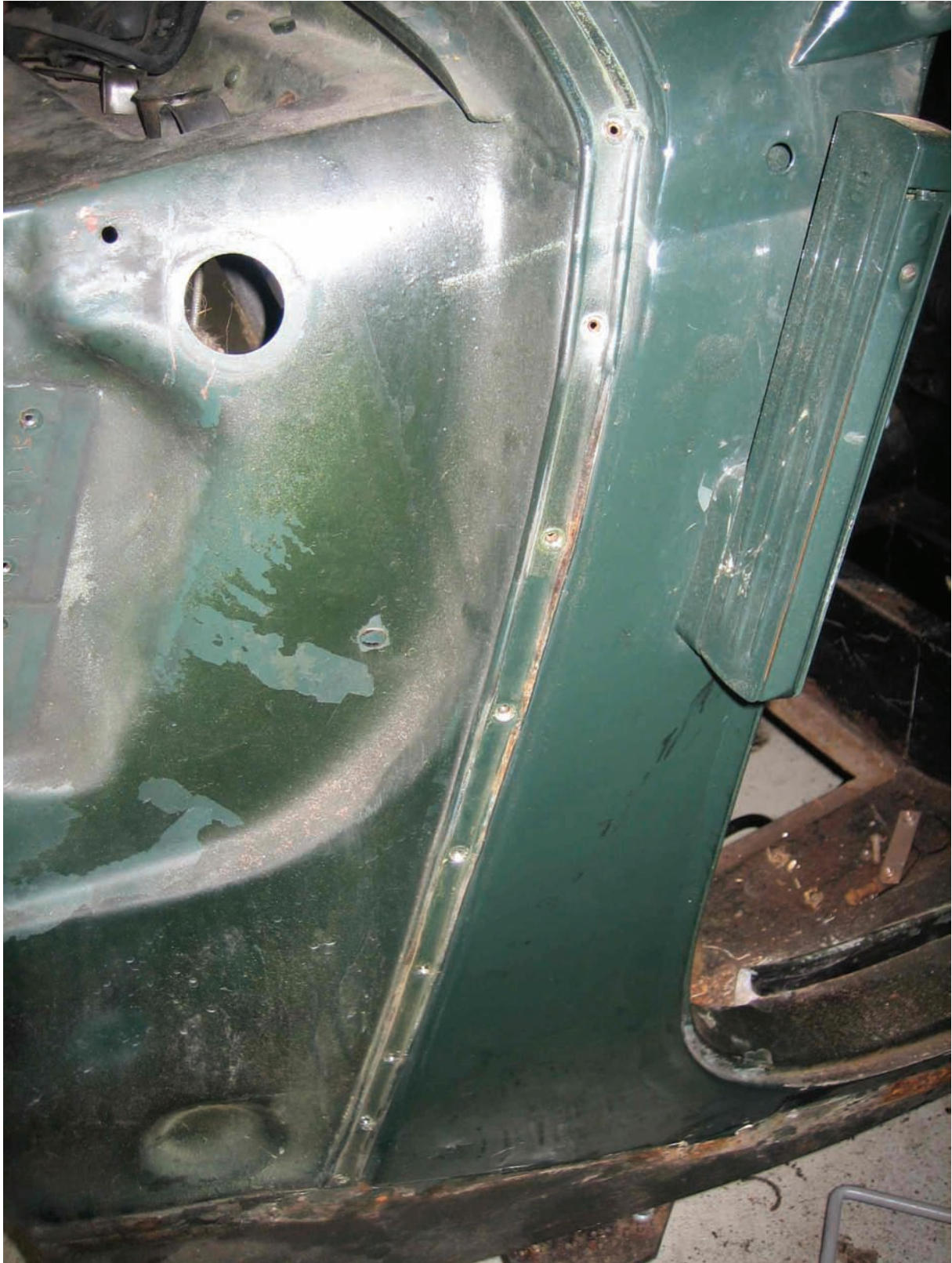
Die A-Säule war ein echter „Blender“ Wassereinbruch am OTP-Scheibenrahmen über Jahre vollführt leise sein Werk, das Holz fiel als Kleinteile unter heraus
