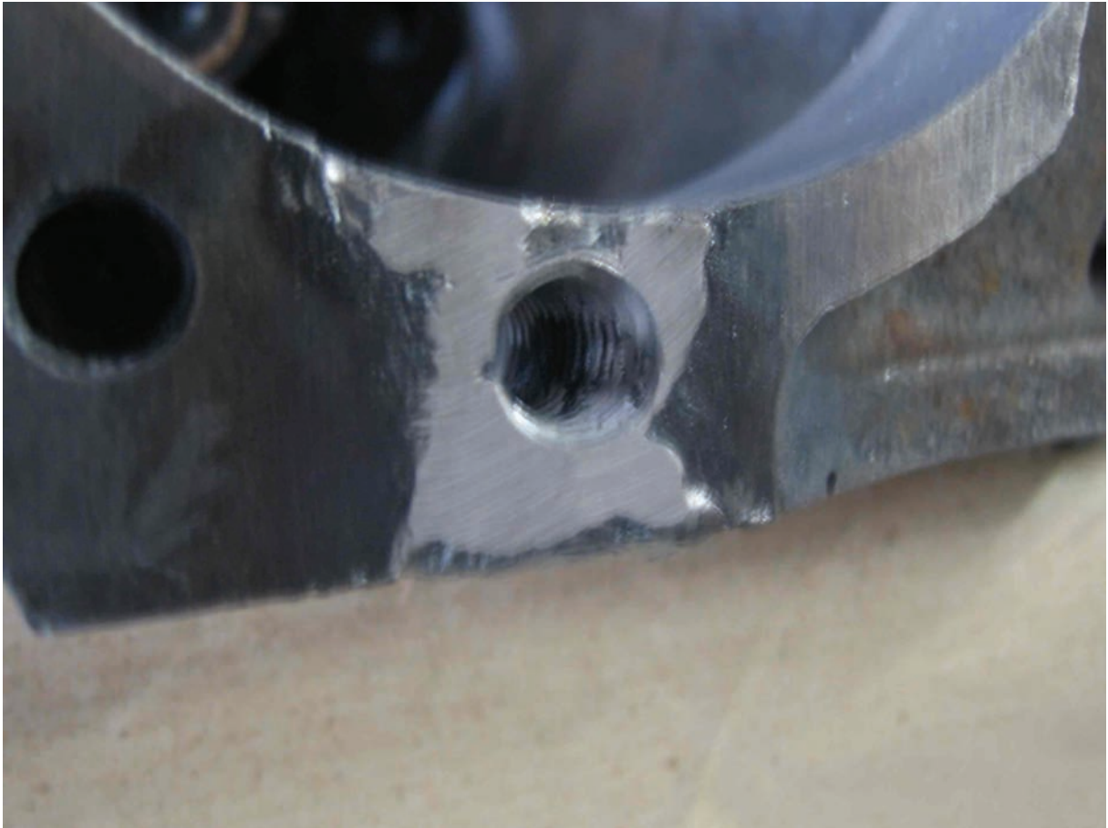
Reparatur Riß Anlasserauge
