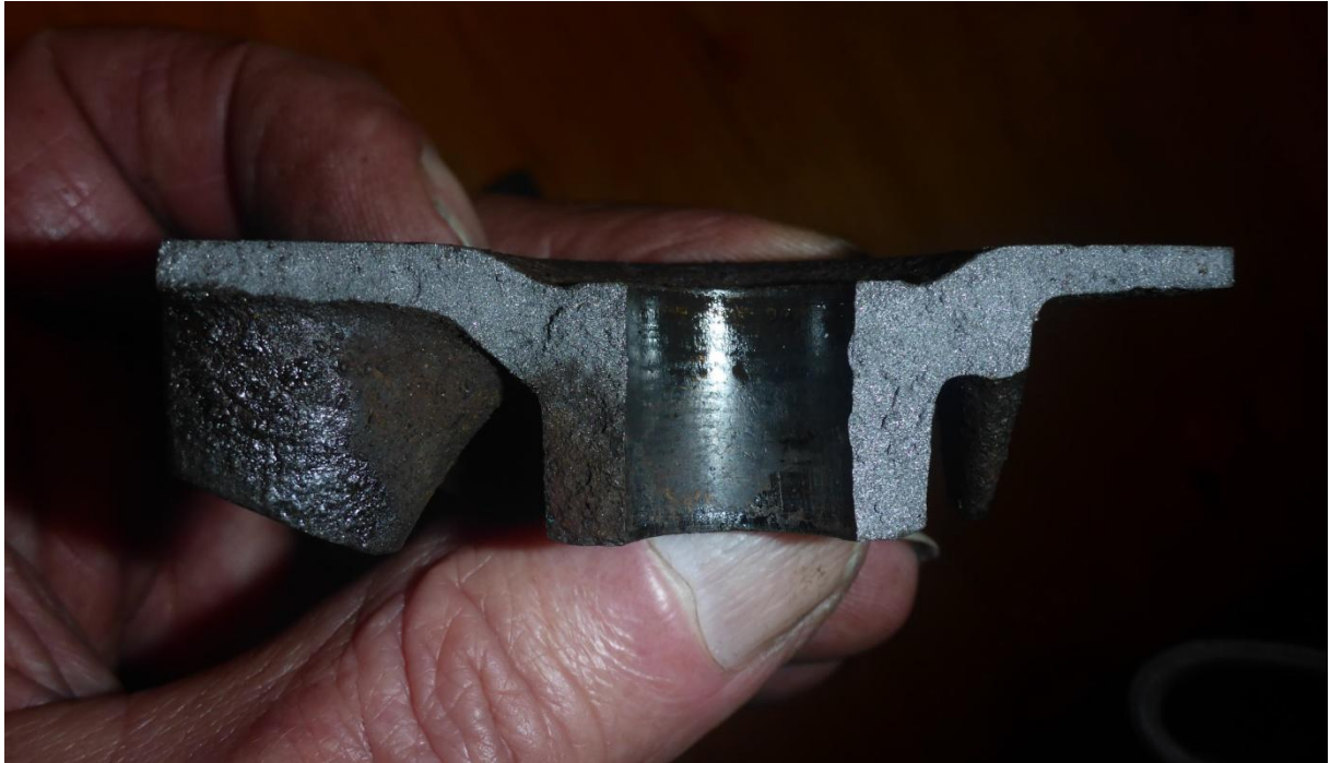
(Gebrochenes Schaufelrad: Mulde)
