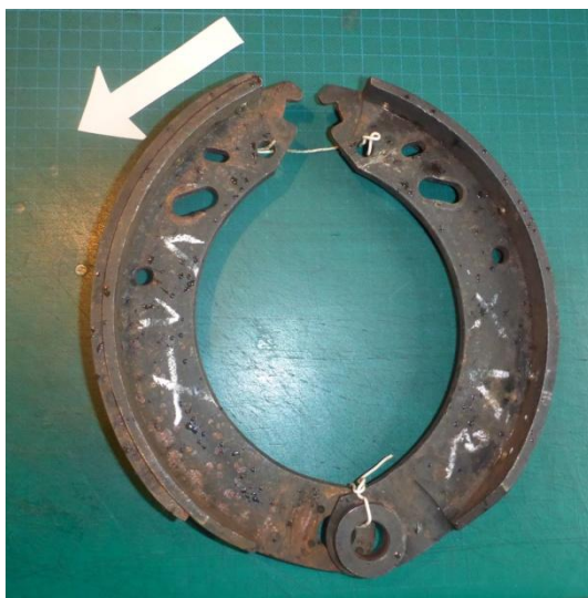
Längere Ansträgung an der auflaufenden Seite des Belags
