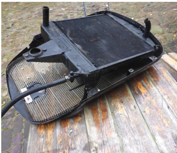
V- Maske mit Va Kühler, beidseitig offen
