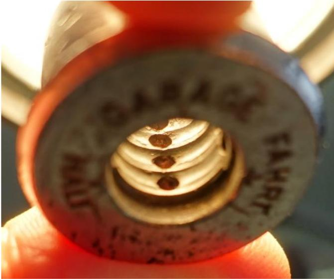
2. Zuerst werden die verschlissenen Laufbahnen herausgefräst
