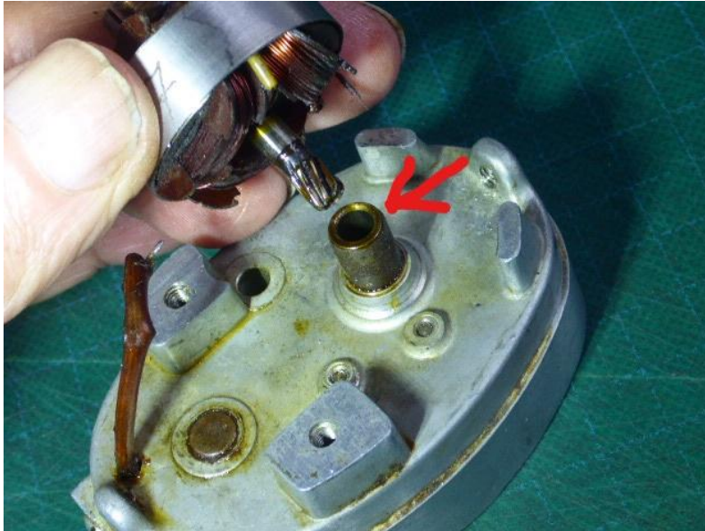
Hauptübeltäter: die Rotorwelle klebt in der Buchse
