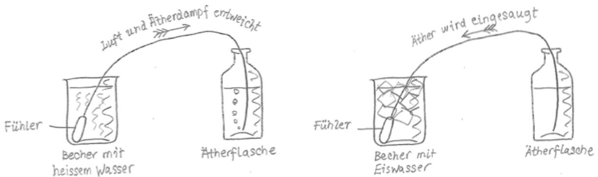
5. Beim Zusammenlöten ist es zweckmäßig, wenn möglich den Fühler im Eiswasser bleiben lassen und jedenfalls nie die Temperatur des Fühlers über etwa  $30^\circ$  ansteigen lassen damit der Äther nicht erneut entweicht.
