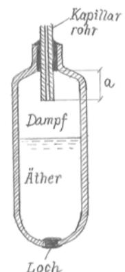
4. Jetzt soll der Fühler mit Äther gefüllt werden. Dabei zwei Becher mit Eiswasser bzw. heißem Wasser anordnen (Zapfwarmwasser reicht aus, der Äther siedet bei etwa  $35^\circ$ ).
