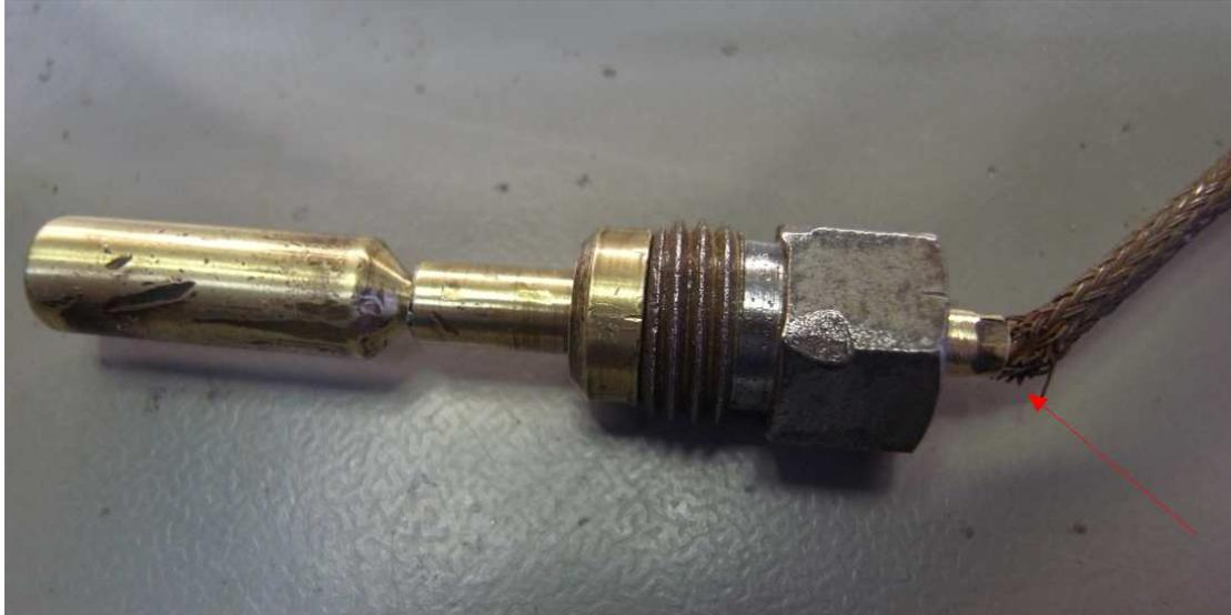
Der erste Schritt ist das Zerlegen des Sensors in die Einzelteile und Entfernen des abgebrochenen Kapillarrohrs. Zinnreste wurden vorsichtig mit dem Bohrer herausgebohrt, so dass auch das Stahlschutzgeflecht wieder hineinpasst.
