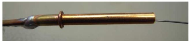
Eine Kupferhohlните wurde als Verbindungsglied angelötet und danach der Stahldraht entfernt.
