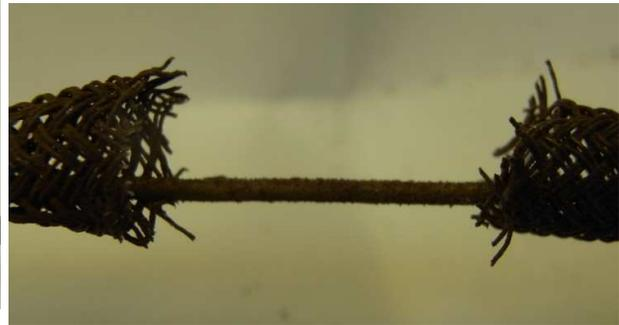
Der Stahldraht wurde jetzt in die Kapillare eingeführt und mit dem Skalpell ein Ringschnitt gemacht.
