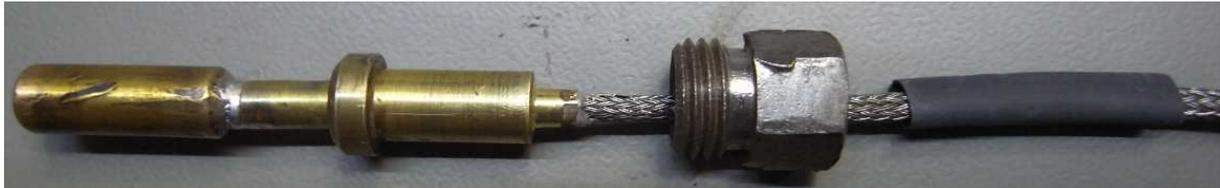
Als nächster Schritt wurde das Stahlgeflecht mittels einem 2K Wärmekleber in die Hülse eingeklebt und am Ende die Hülse leicht gestaucht. Ein Stück Schrumpfschlauch wird zumindest bei dem Transport bzw. Einbau einen weiteren Knickschutz darstellen, kann aber leicht entfernt werden.
