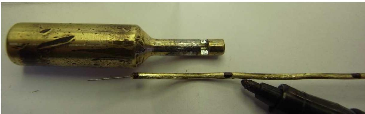
Nach dem Einlöten wird die Verschraubungsmuffe aufgesetzt und ebenfalls verlötet. Der Stahldraht ist immer noch in dem Kapillarrohr.
