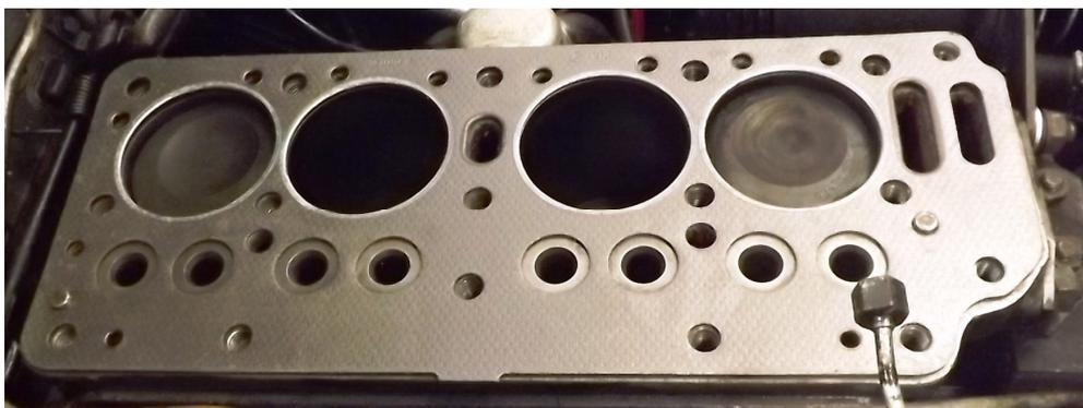
Ist dann noch der Block versottet/der Zulauf dicht, ist eine Überhitzung des Motors vorprogrammiert. Vor allem der 3. und 4. Zylinder bekommen von der Kühlung, auch des Flügels/Lüfters am wenigsten mit. Ein fataler Umstand.
