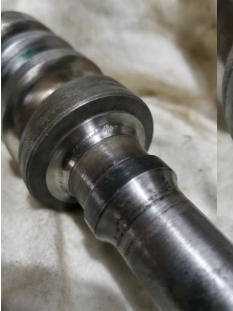
Macke in der Kugellaufbahn Lenkungsschnecke
