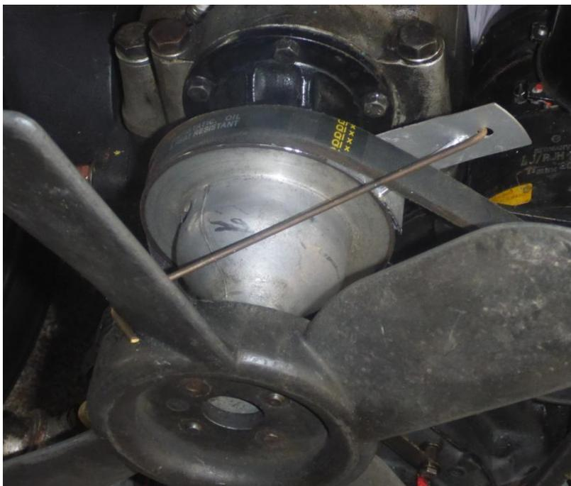
Wenn der Hebel über dem Keilriemen steht, kann man einen etwa 17 cm langen Drahhaken in das Loch im Hebel einhängen, das andere Ende des Hakens wird dann hinter einen Lüfterflügel gehängt.
