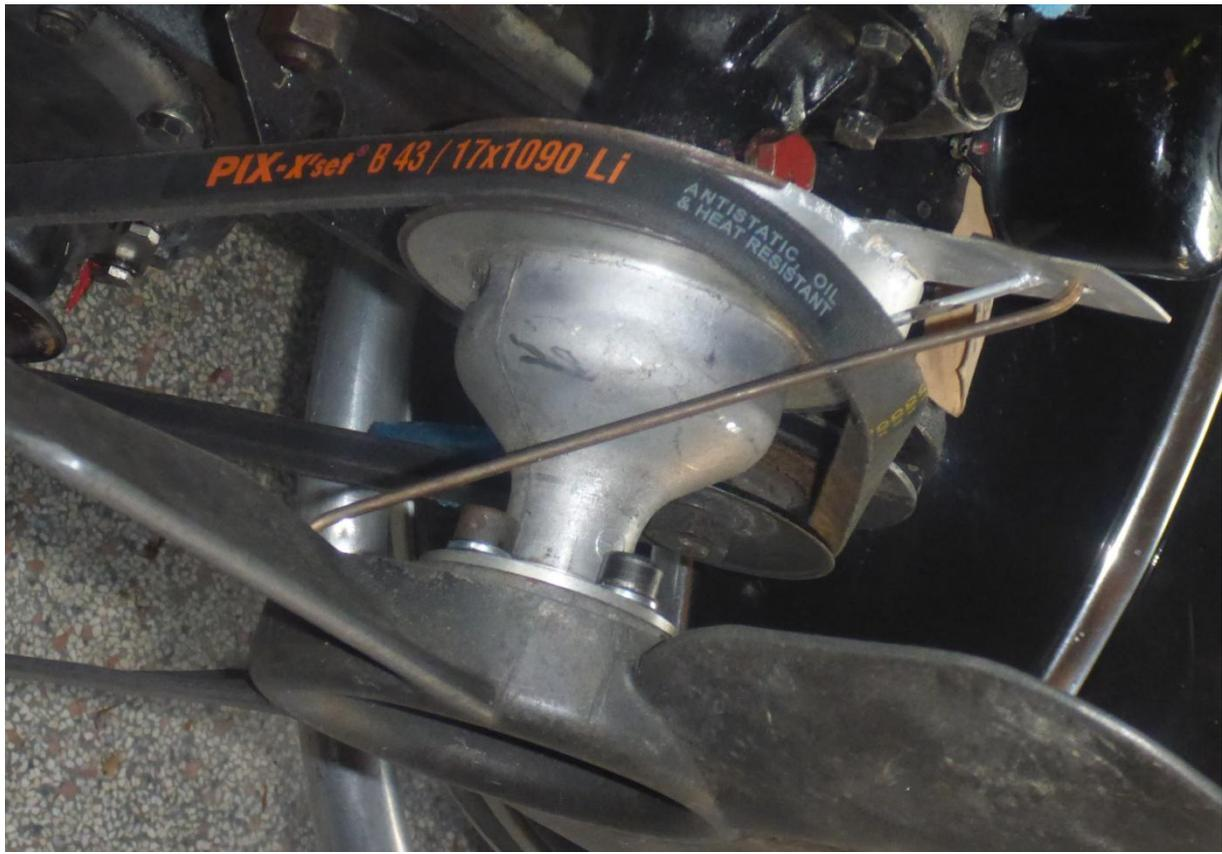
Dann am Lüfter weiter gegen die Drehrichtung des Motors drehen. Der Keilriemen wird abgelegt.
