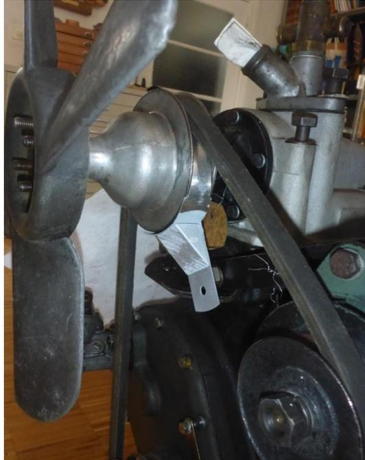
Den Lüfter entgegen der Drehrichtung des Motors drehen und gleichzeitig das Werkzeug am Hebel in die gleiche Richtung ziehen.
